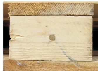
Atļauts izmantot labotas paletes, paletes remontam jābūt apliecinātam ar remonta naglu. Koka sastāvdaļām, kuras izmantotas remontam, jābūt jaunām un tām jāveic fitosanitārā apstrāde.
