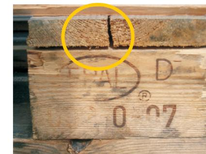
Atļauts izmantot paletes, kurām ir ieplaisājis paletes šķērseniskais dēlis (vidū, malā), taču ar nosacījumu, ka visa šķērseniskā dēļa virsma balstās uz zem tā esošajiem blokiem.
