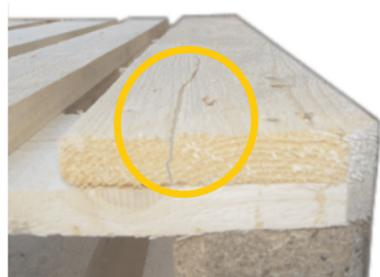
Paletes, kuru dēļi ir ieplaisājuši, atļauts izmantot tikai tad, ja plaisu šķautnes nav atdalījušās (plaisa drīkst būt visa dēļa garumā ar noteikumu, ka abas dēļa daļas ir pienaglotas).
