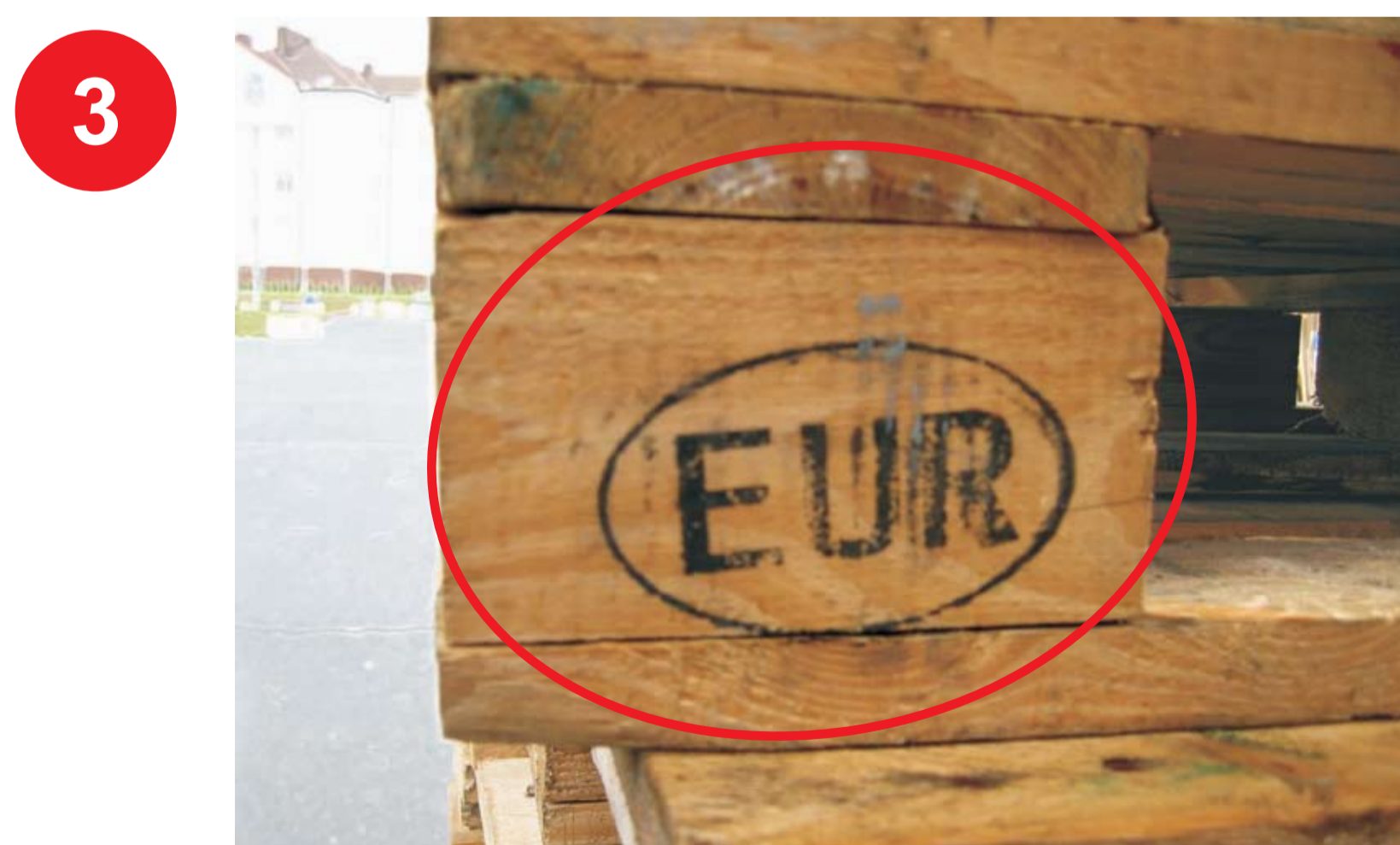
3 Nieprawidłowe oznakowanie na wspornikach.
