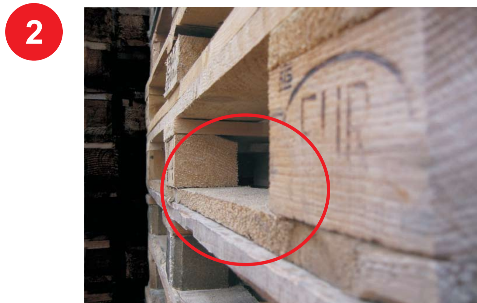
2 Brak frezów na górnych krawędziach desek dolnych lub brak ścięć narożników palety.
